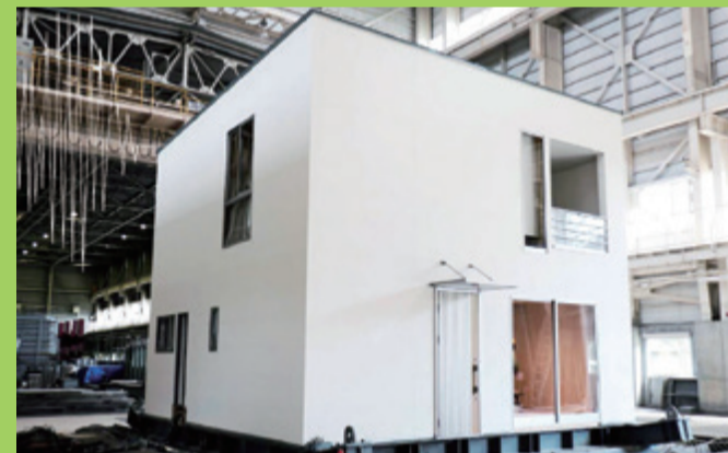
■ウッドワンでは同構造の建物で10回連続で震度7の地震を想定した加振実験を行いました。
